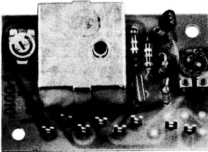
Die Rauschsperrrebaugruppe ermöglicht sowohl die Unterdrückung des zwischen den Sendern auftretenden Rauschens und bewirkt gleichzeitig die definierte Anzeige der Feldstärke. Mit Hilfe eines Reglers läßt sich der Schwellwert der Rauschsperrre einstellen,
