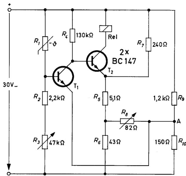
Diese Temperaturregelschaltung benötigt zu ihrem Betrieb eine Gleichspannung von 30 V. Sie ist für einen Temperaturbereich von 30 bis 90 °C ausgelegt. In einem Anwendungsfall traten im Bereich von 50 bis 90 °C Temperaturabweichungen bis  $\pm 3$  grad, im Bereich von 30 bis 50 °C bis  $\pm 2$  grad auf.  $R_3$  ist ein in Temperaturwerten geeichter Drehwiderstand zum Einstellen des Sollwertes, der NTC-Widerstand  $R_1$  (2322 636 01154) dient als Istwertaufnehmer.
